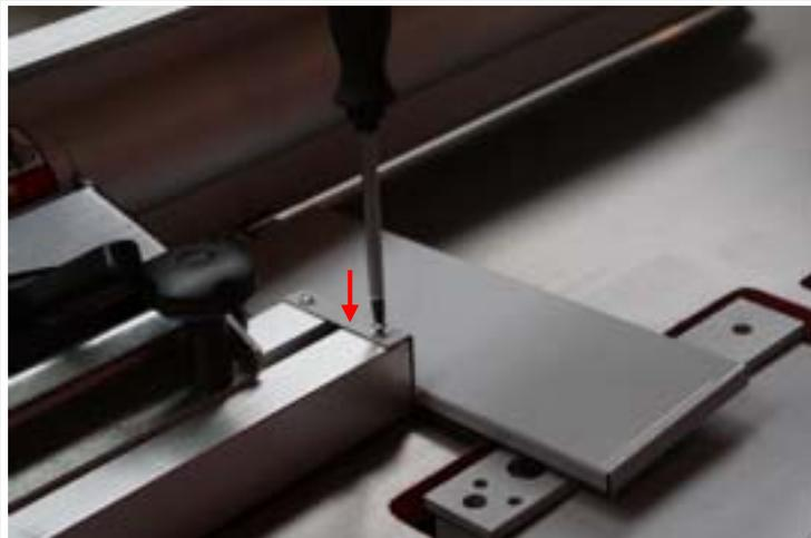
Hobelwellenabdeckung mit den zwei Kreuzschrauben montieren.
