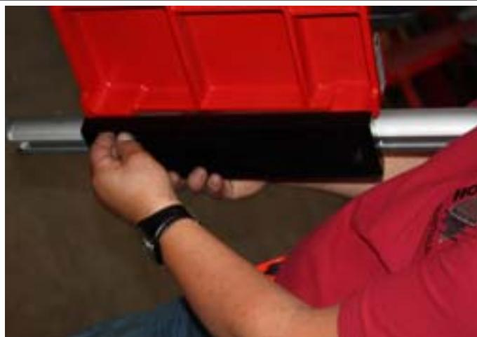
Führungsschiene zu Parallelanschlag mittels 2 Innensechskantschrauben an den dafür vorgesehenen Bohrungen am Eingangstisch fixieren.
