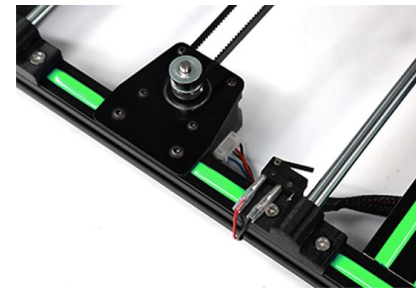
Y Axis Motor Y Axis Limit Switch
